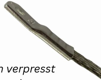
Ein EMV-Masseband sollte nicht mit einem Rohrkabelschuh verpresst werden, da dies die EMV-Eigenschaften negativ beeinflussen kann. Der Grund dafür ist, eine Reduzierung der Kontaktfläche. Dies führt zu einem erhöhten Übergangswiderstand und somit zu einer schlechteren Masseverbindung und unerwünschten EMV-Effekten.
