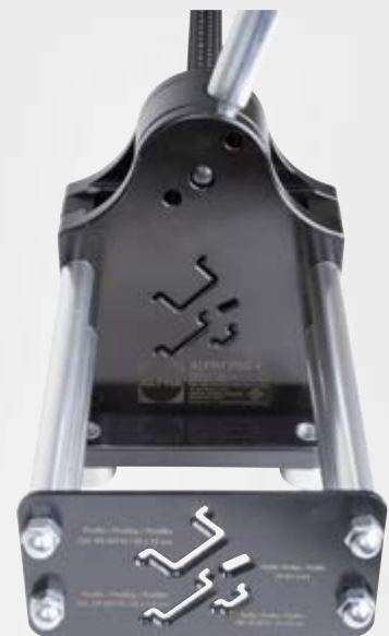
Führungsvorrichtung zum 90°- winkelgenauen Schneiden
