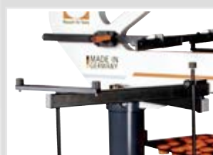
Schwenkbare Abstützarme, höhenverstellbar mit je 3 Gummiauflagen
