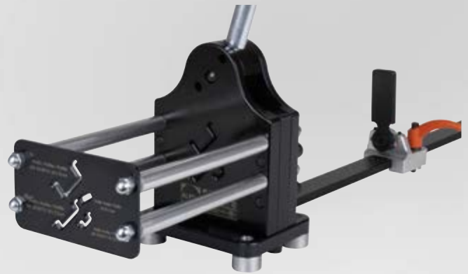
Führungsvorrichtung zum 90°- winkelgenauen Schneiden
