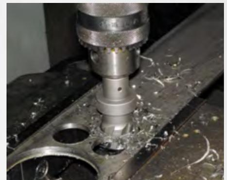
Bohren in Flachstahl
