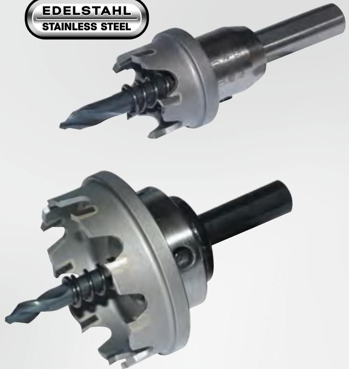
Der Einsatzbereich von Hartmetall-Lochsägen unterscheidet sich von HSS-Bi-Metall Lochsägen. Mit ALFRA hartmetallbestückten Lochsägen können wirtschaftlich Edelstahl bis 2 mm ( $\frac{1}{16}''$ ), unlegierte Stähle bis 4 mm ( $\frac{3}{16}''$ ), Kunststoffe, PVC, Aluminium, Zink, Gips und Leichtbauplatten u. a. verarbeitet werden. Zum Einsatz für Hand- und Säulenbohrmaschinen. Bei Säulenbohrmaschinen kein automatischer Vorschub.
