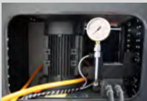
Zweikreishydraulikaggregat im Schrankunterbau
