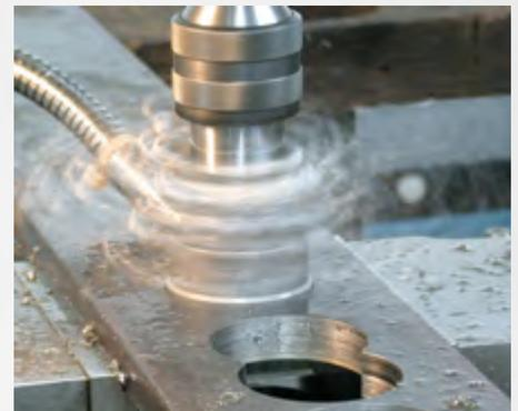
Bohren in Flachstahl
