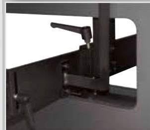
Anschlagsystem in Y-Richtung verfahrbar, 2 Führungswellen im Presskörper.
