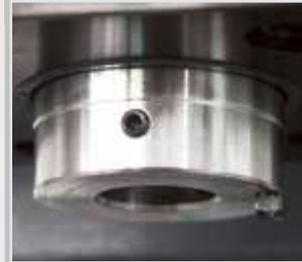
Stabile Kolbenstange (Ø 55 mm) mit Werkzeugverdrehungssicherung
