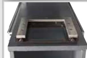
Matrizenaufnahme, Werkzeugwechsel auch bei eingelegter Schaltschranktür
