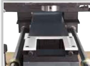
Matrizenbettaufnahme. Werkzeugwechsel auch bei eingespannter Schaltschranktür.
