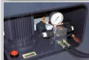
Zweikreis hydraulikaggregat im Schrankunterbau
