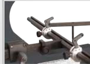
Längen- und Tiefenanschlag mit klappbaren Nachsetzanschlägen
