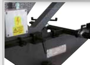
Längen- und Tiefenanschlag mit klappbaren Nachsetzanschlüssen (Option)
