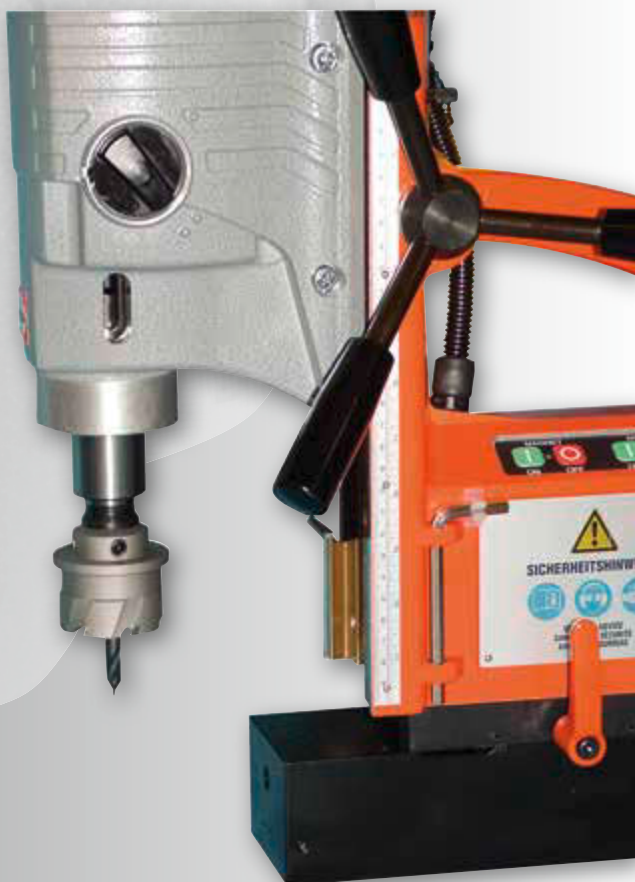
MBS-Pro Anwendung auf Rotabest-Magnetbohrmaschine mit MK3 – Aufnahmehalter. Art. Nr.: 0734003
